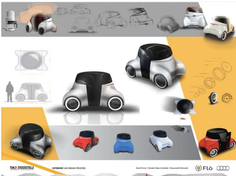
Confondendo i confini tra design automobilistico e di prodotto, il corpo avvolto intorno alla cabina crea una vettura unica. Eliminando la convenzione di zona anteriore e posteriore, Flò è progettata per essere bi-direzionale.
